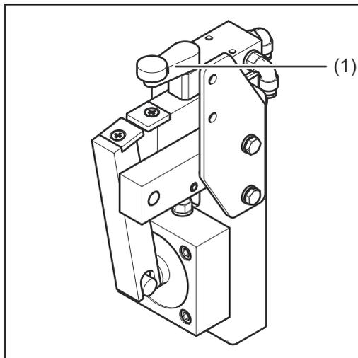
Si un cuello antorcha empuja la palanca de válvula (1) con la tobera de gas más que 15° hacia un lado, se activa el cortador de hilo y se corta el electrodo de soldadura.
